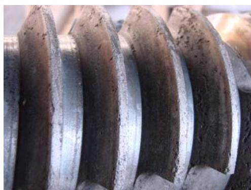
Fig. 4. Udsnit af kasseret extrudersnegl fremstillet i X12CrS13: 12 % Cr, 1 % Ni, bal. Fe.
