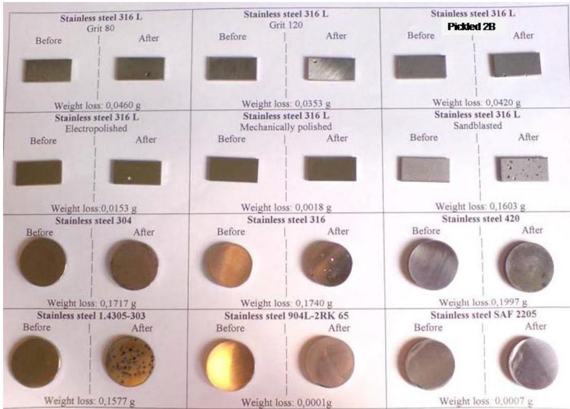
Fig. 7. Rustfri stål overflader før og efter eksponering i 6 %  $\text{FeCl}_3$ , 48 timer, stuetemperatur (modificeret ASTM G48). Øverst ses 6 forskellige overfladefinish på AISI 316L, nederst 6 forskellige rustfri stål.
